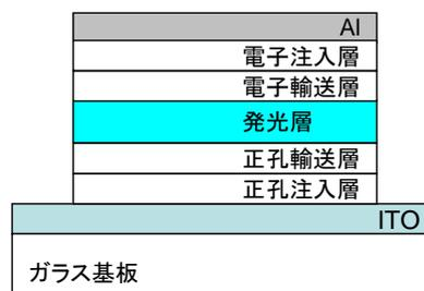
図1-1-3 積層型有機デバイスの構成例
