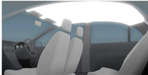
図1-1-2 自動車の天井に設置した有機EL照明（コニカミノルタHP より）
