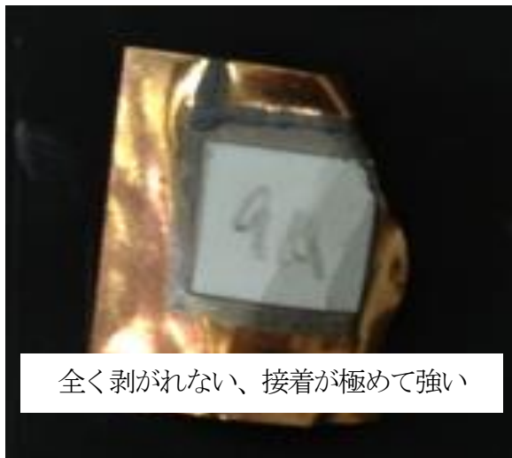
図一3 接着が極めて強い判定◎の接合状態図
