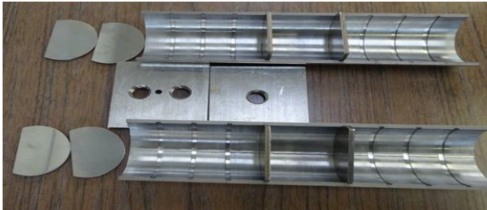
図6 混合器 (溶接前)
