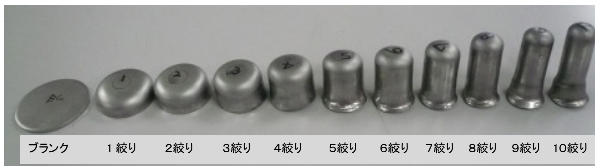
図 1-11 10 工程セラミック金型による成形品
