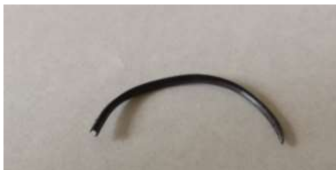
図2-2-2-2 変形プラスチック針 (PPS-CF40-01)
