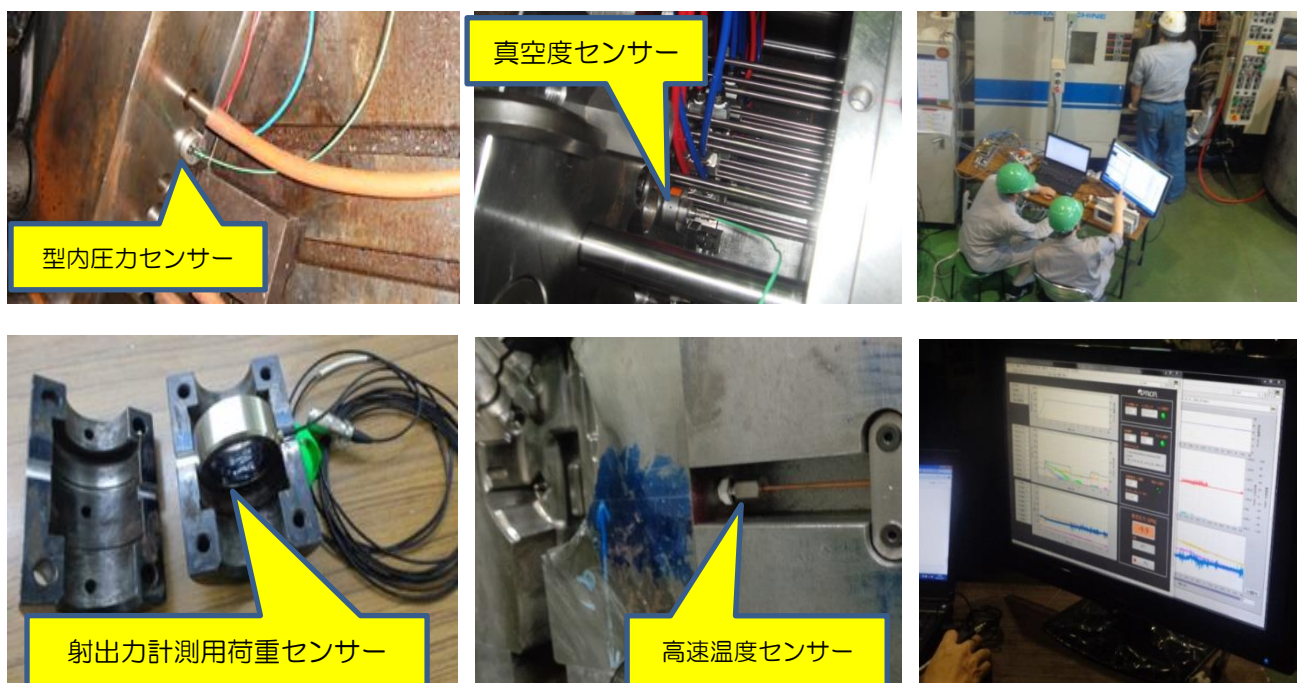
図9. 各種センサー設置例・試作鋳造時の計測・計測時の表示画面
