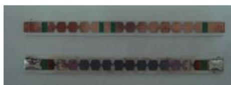
図2. 13S1P 溶断試験前後
