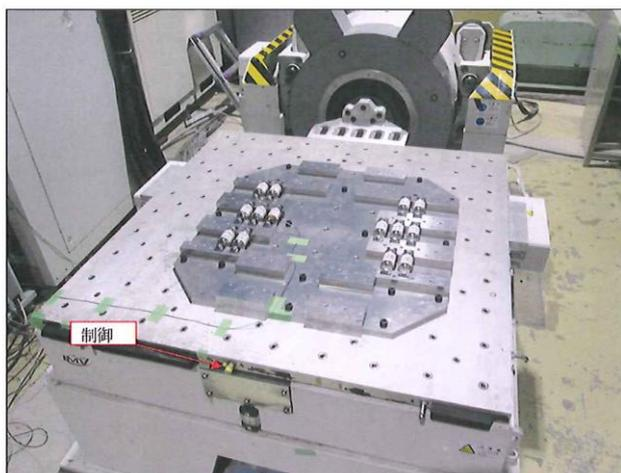
図5 振動試験装置への供試品設置状況
