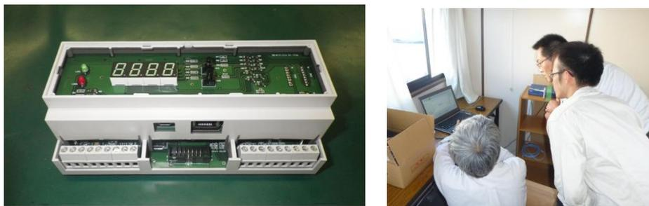
Fig.17 試作制御装置と現地動作確認・開発風景（冷凍機とは別の小屋からの操作）
