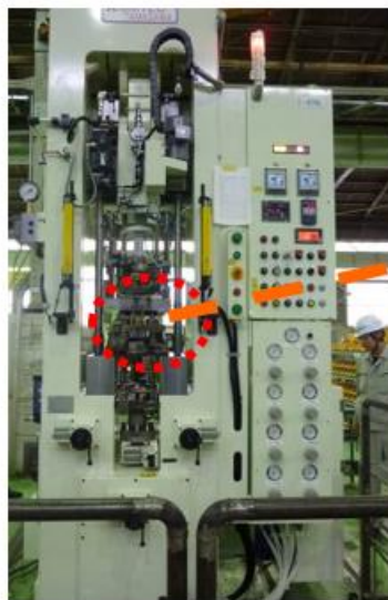
図-66： 摩擦・摩耗試験機（実機相当試験機）へノズル搭載
