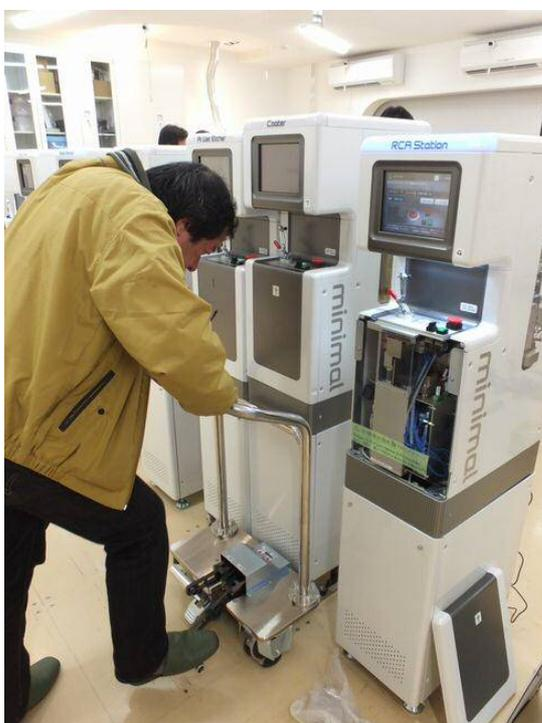
図21 ミニマル装置実機へのドッキングステーション適用
