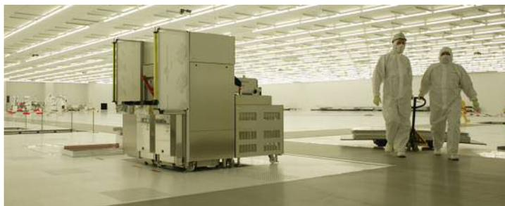
図2 半導体製造装置は、サイズが個々に異なり、床にはアジャスターで設置するだけである。
