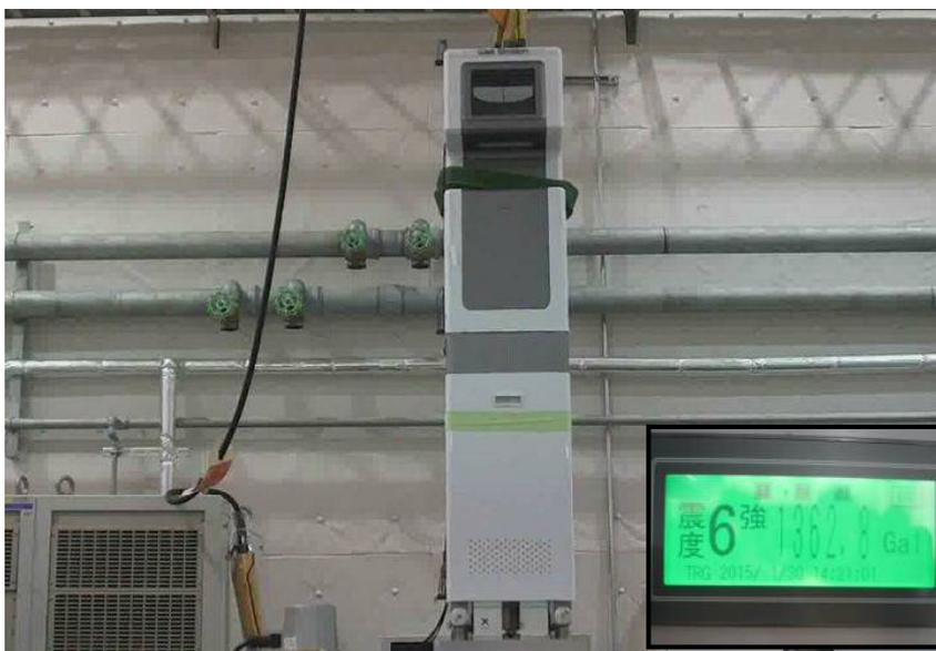
図9 耐震強度試験
