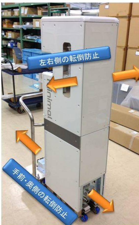
図14 装置搭載時の装置転倒防止
