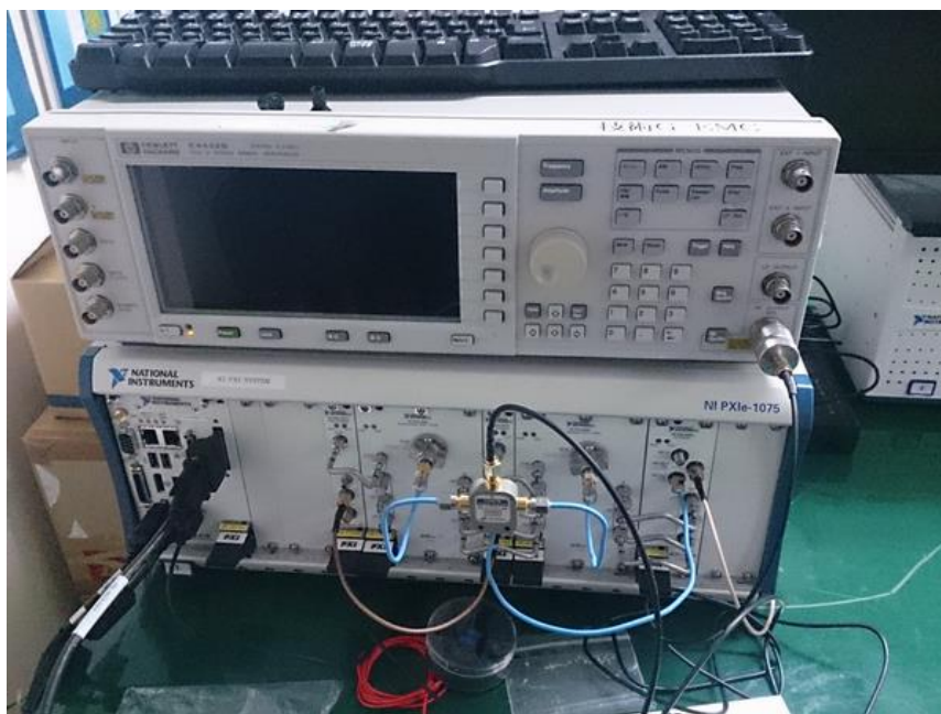
図8 PXI による位相差測定装置の検証システム概要
