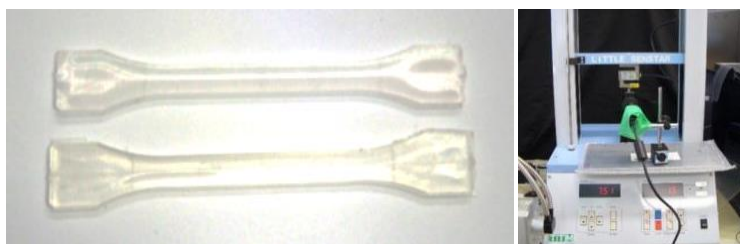
図 2-14 試作したダンベル片と引張試験機
