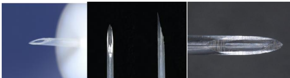
図 2-5 樹脂製注射針の先端部の拡大写真（先端部がより鋭角となった）
