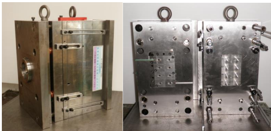
図 2-8 完成した金型
