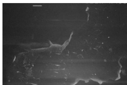
図 2-3-2-13 積層フィルムの SEM 写真
