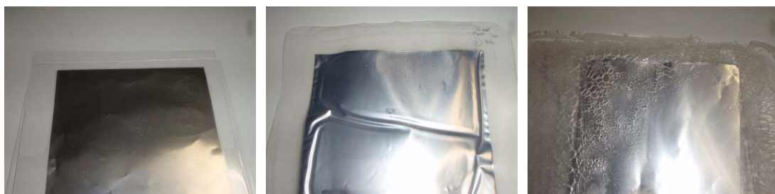
図 2-4-2-2 PP の加工結果 (左: IH 出力 20%, 中: IH 出力 40% 右: IH 出力 60%)
