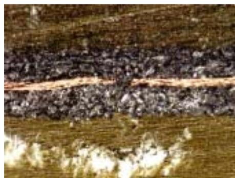
図9 穿孔 Cu 箔の塗工断面
