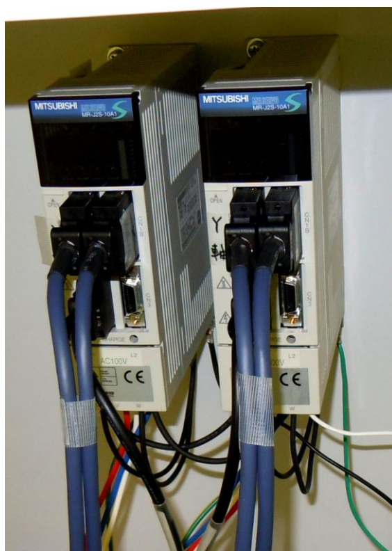
写真 4 (b) . ステッパ機構に設置したサーボアンプ
