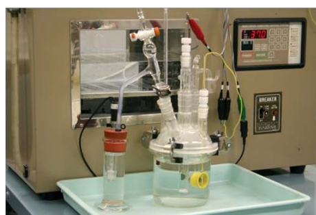
図2-1-17: 高生体適合性Ti合金表面に生成する不動態皮膜の電気化学的安定性の評価
