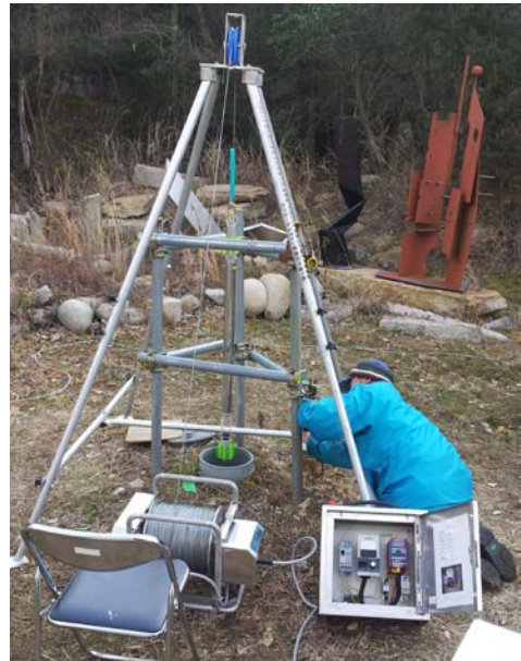
写真2-7 プローブを引上げた時の状況
