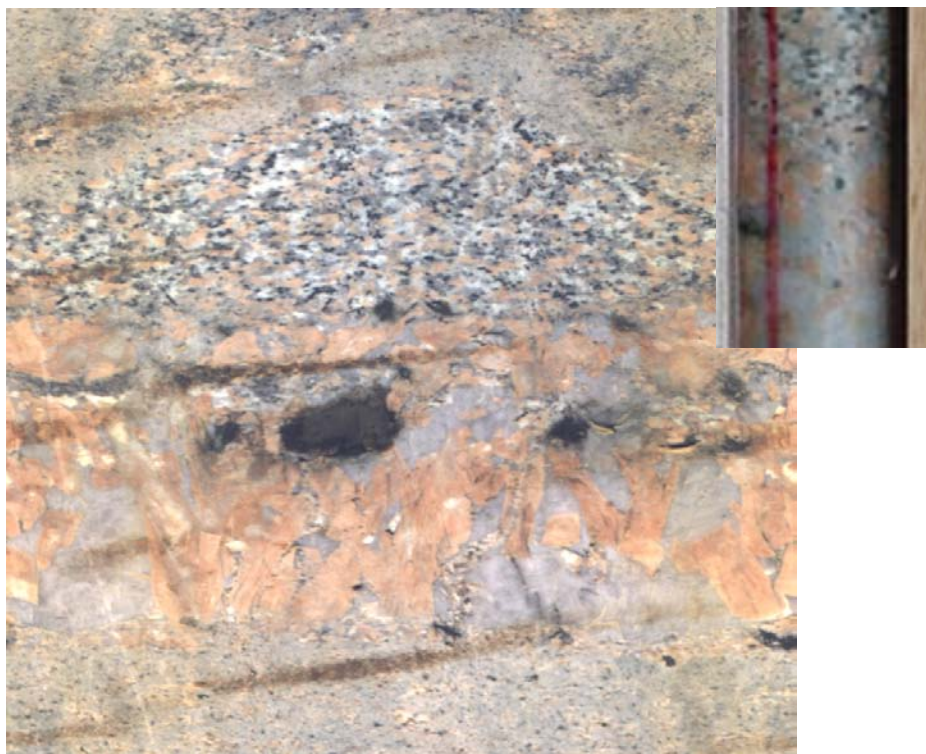
図 2-5 660.2m 深度付近の地層変化の観測画像（試作Ⅱ号機使用） （写真右上にこの展開画像に該当する付近のコア写真を示す）
