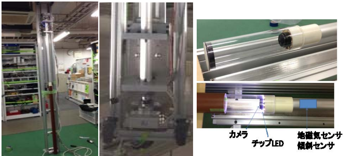
写真 2-1 装置全体 写真 2-2 回転部 写真 2-3 センサーヘッド部
