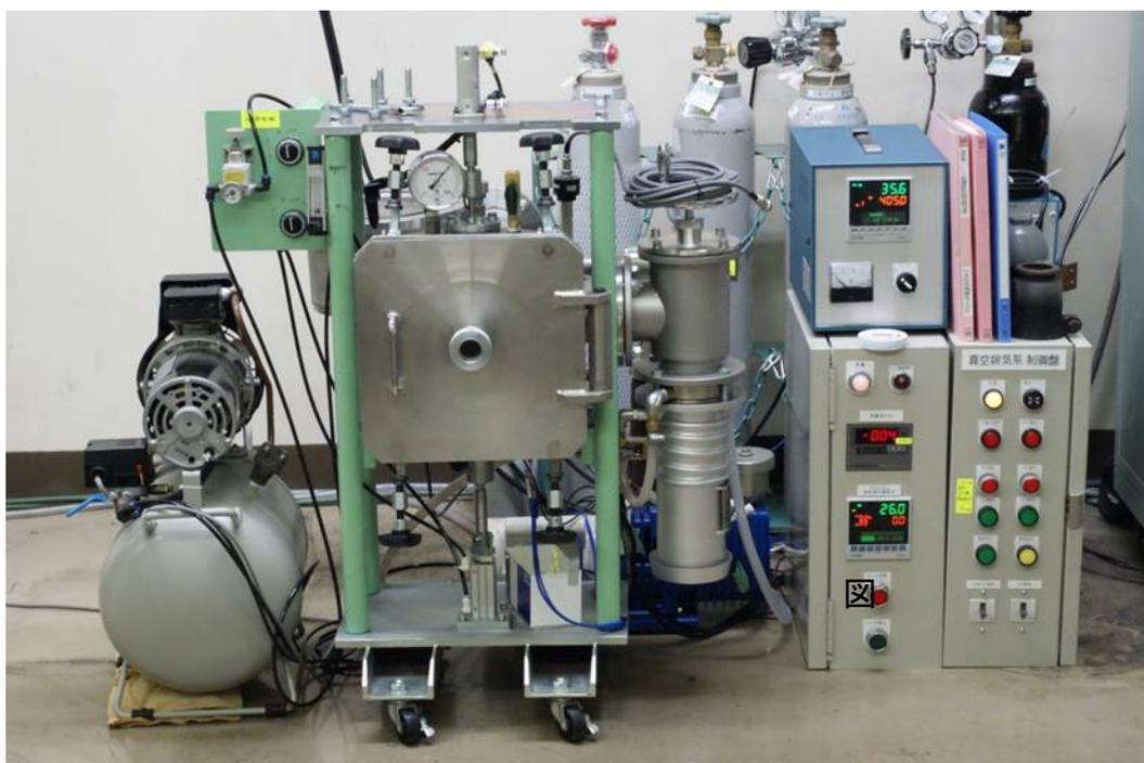
図4 無加圧接合に用いた試験装置
