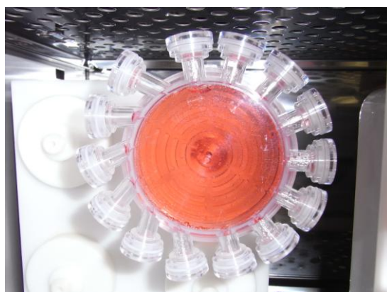
写真 2-1-2 大型ベッセル培地充填状態（密閉性評価）
