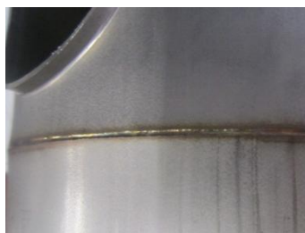
図 2-2-2 バーリング部付近の溶接部
