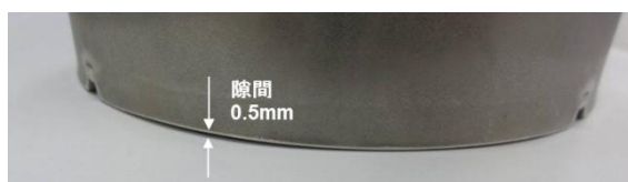
図 2-2-3 プレス絞り加工品 端面状況
