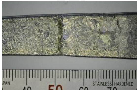
③-2-図 3 曲げ変形および試験体表面（試験体 2）
