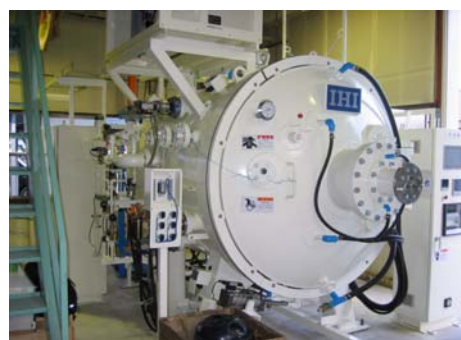
図 1.1 高圧窒素ガス急冷却真空炉
