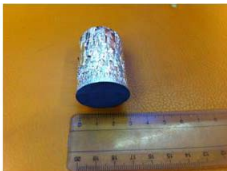
図2 精製したマグネシウムインゴット
