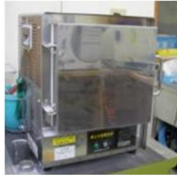
図4 電気炉（ファーンネス）
