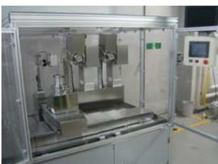
図2-4-1開発した研磨装置
