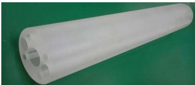
図2-2-1  $\phi 50\text{mm}$ 母材写真
