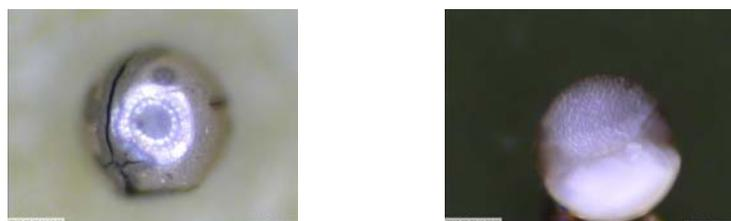
図 2.3.13 耐熱試験後サンプルボール (右は左の金属皮膜を剥離したゴム部)
