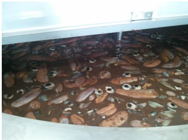
写真 5 溶解槽に投入したイカゴロ
