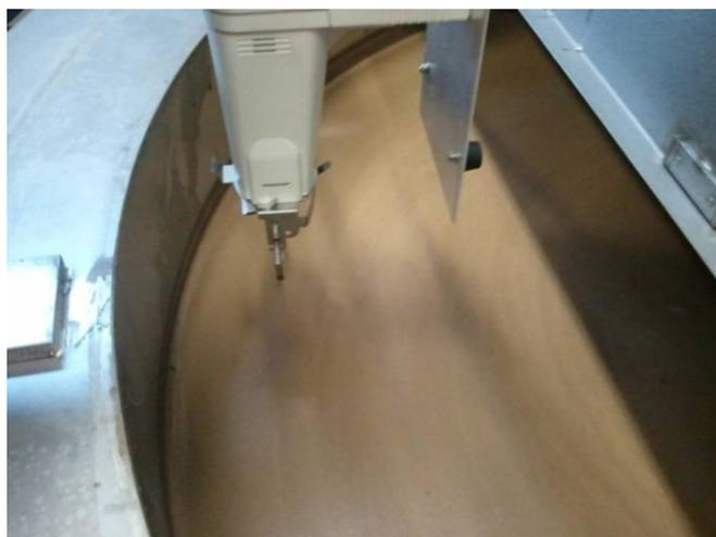
写真 6 溶解したイカゴロ及び粘度計による計測状況
