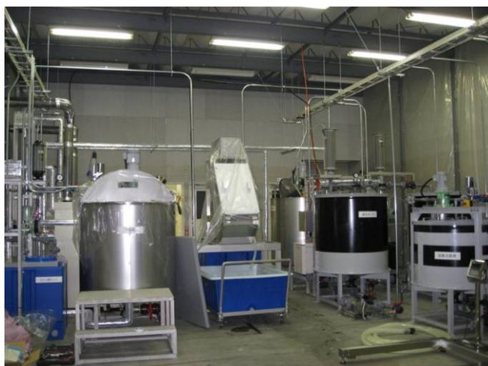
写真 3 イカゴロ溶解脱カド自動化装置
