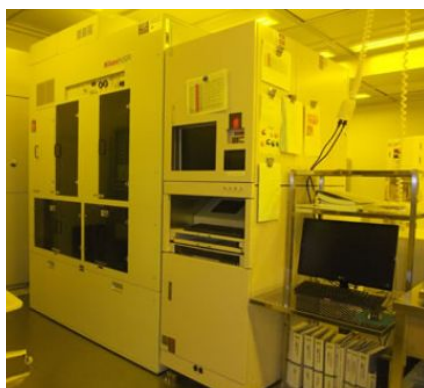
図17 プロセス評価で用いた露光装置 図18 露光の解像力試験結果
