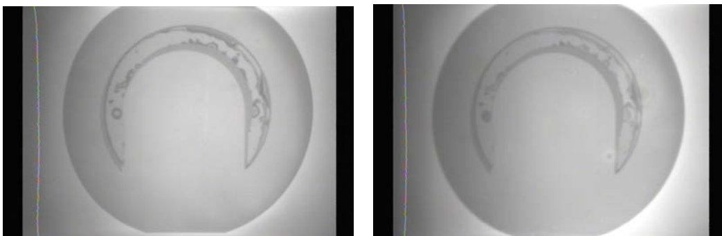
図6 加熱試験前のシリコンキャリア赤外像と 10 回の加熱試験後のシリコンキャリア赤外像
