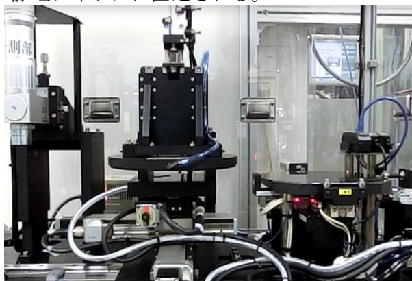
図15 接合用キャリア位置制御装置 図16 試作された搬送用キャリア
