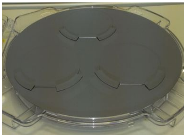
図 2 0 試作された 12 インチイオン注入用接合キャリア
