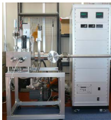
図1 試作された6インチ対応・接合用プラズマ装置
