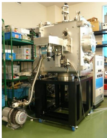
図 10 試作された 8 インチ対応・接合用プラズマ装置 図 11 アトムソースイオン源
