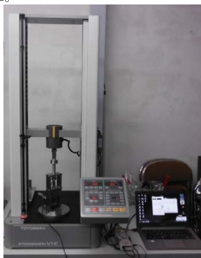
図 2 1 接合力の評価に用いた引張試験機
