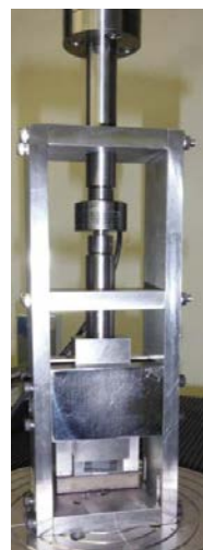
図 2 1 接合力の評価に用いた引張試験機
