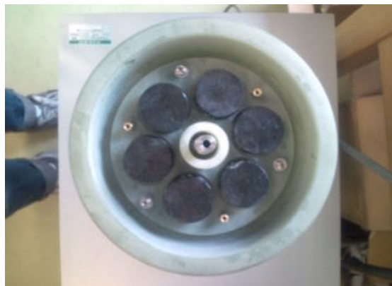
図7 液体窒素容器（クライオスタット）内に装着したバルク超伝導体
