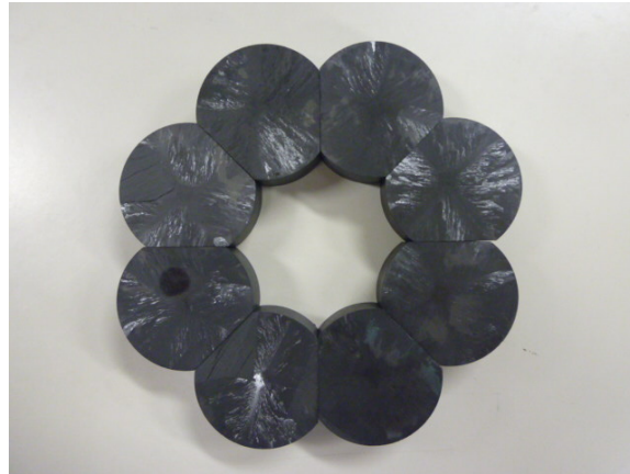
図 2 回転トルク伝達機構用のバルク超伝導体の配列
