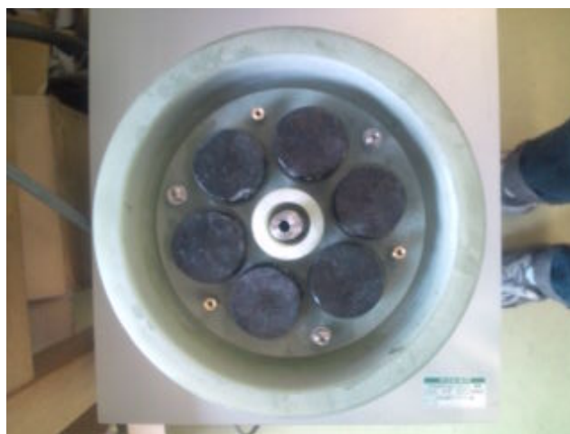
図3 クライオスタット設置したバルク超伝導体。
