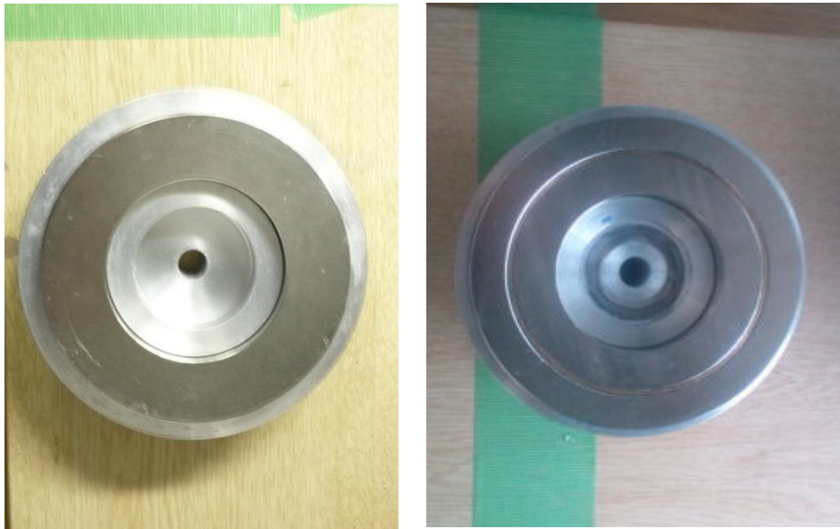
図 1 剛性力測定用の Fe-Nd-B リング磁石。左図が単極リングであり、右図が NS2 極リングからなる。
