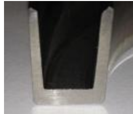
図 2-31 シゴキ工程サンプル断面
