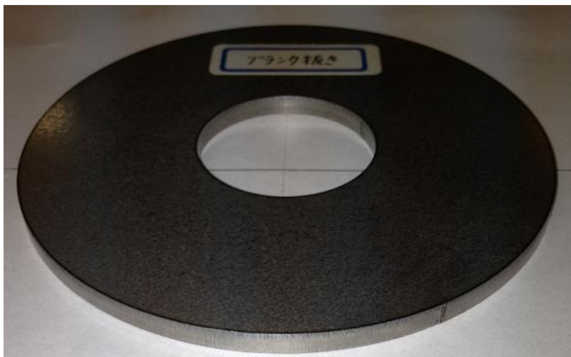
図 2-7 計算結果を基に作製したブランク
