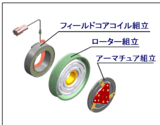
図 1-2 電磁クラッチ内部品構成
