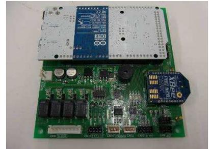
図 2.1.1.3 前処理基板
