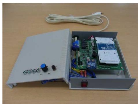
図 2.1.3.4 2次元温度センサ前処理基板収納筐体
