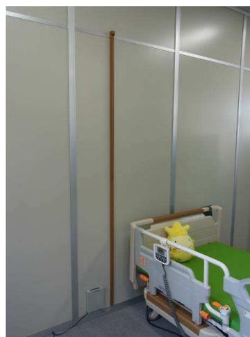
図 2.1.3.6 2次元温度分布センサ取り付け部
