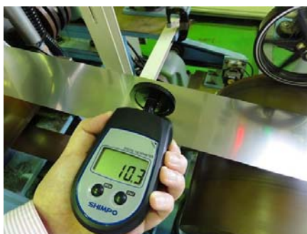
図 2-3-1 速度計による通板速度測定の様子
