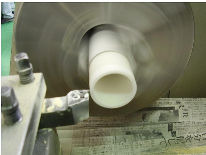
外形加工切削条件Aによる切削の様子。
