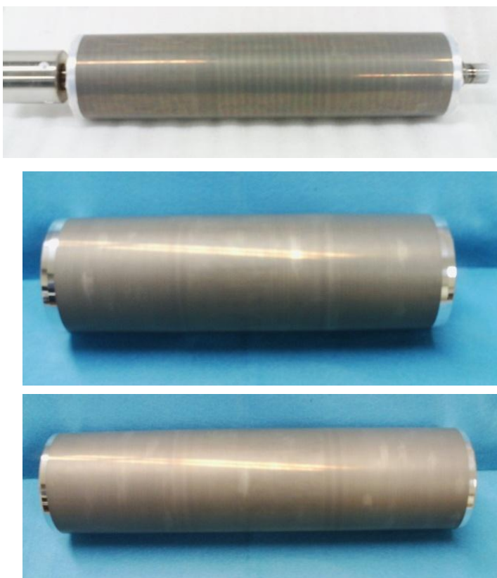
図 2.3.3.1 実機装着試験用ロールへの成膜例
