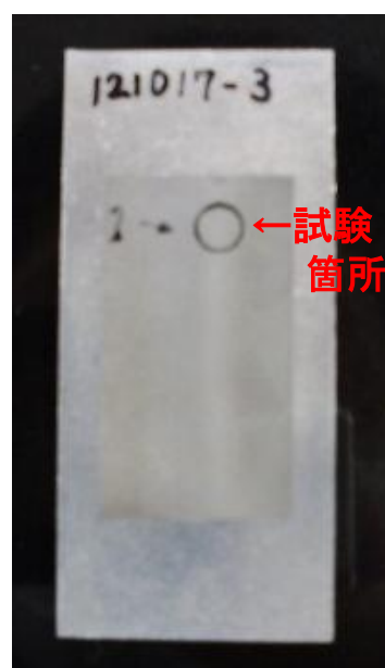
図 2.2.2.2 耐磨耗試験条件と試験片の外観
