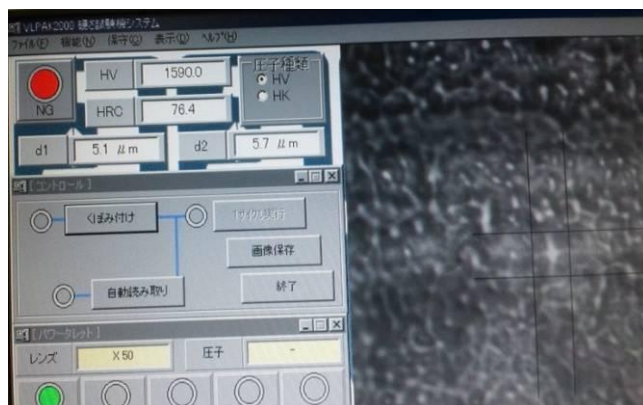
図 2.2.2.1 ビッカース硬度測定の場合
