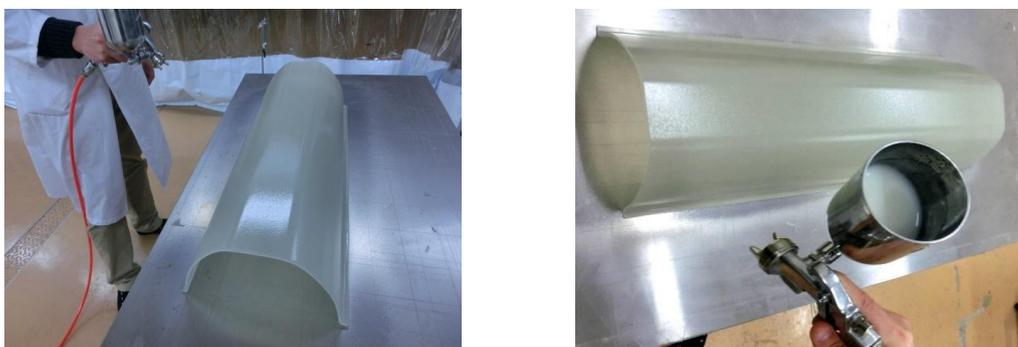
図16 試作照明カバーのスプレー塗工
