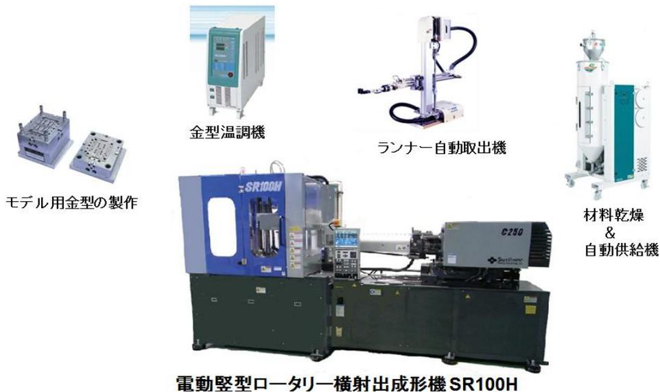
第 2.1.3-1 図 車載用複合部品一貫生産体制構築のため導入した周辺設備
