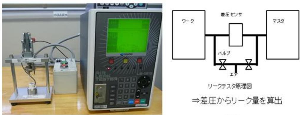
第 2.4-1 図 測定機外観および原理図
