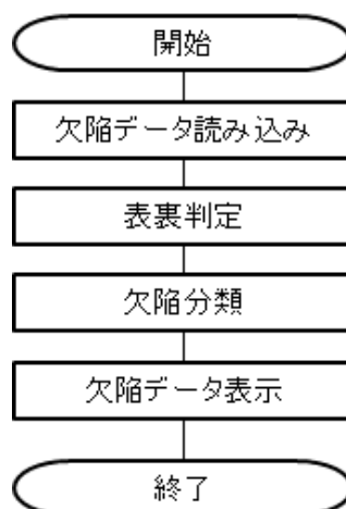
図 155 欠陥分類結果表示ソフトウェアのフロー
