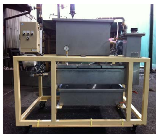
＜写真：孔拡散型水処理装置＞
