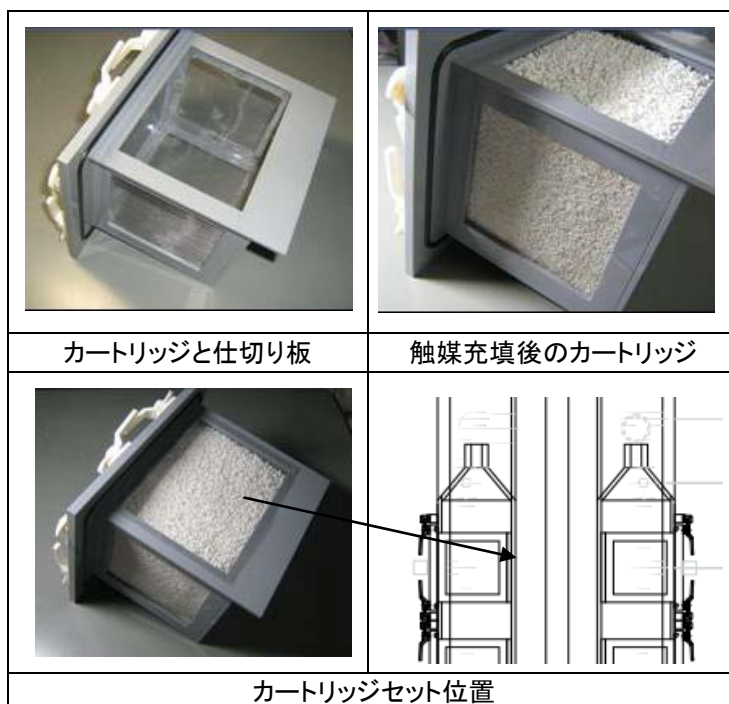
＜収着剤充填部構造と仕切り板＞
