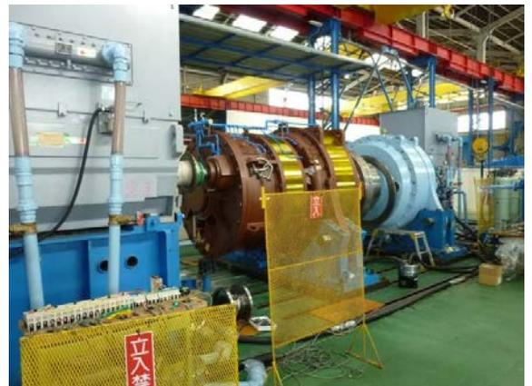
写真 2-4-1 負荷試験装置実機
