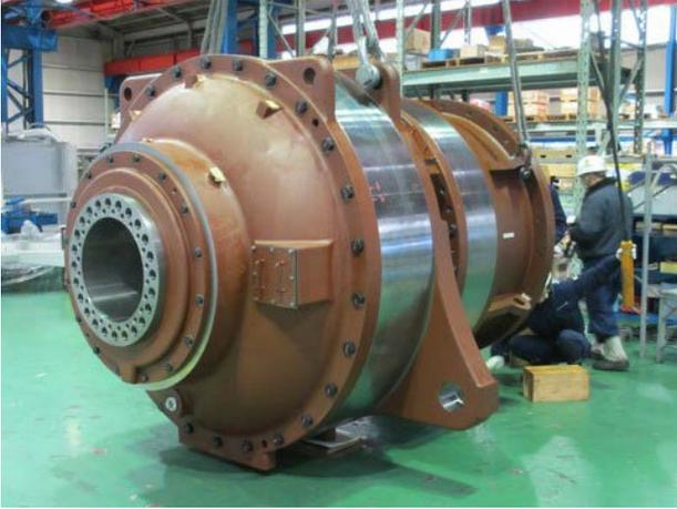
写真 2-2-1 ギヤボックス完成（1）
