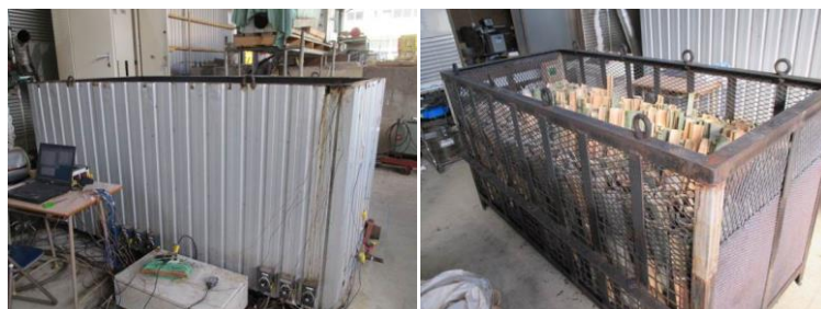
SHS 処理装置の外観およびかごの様子
