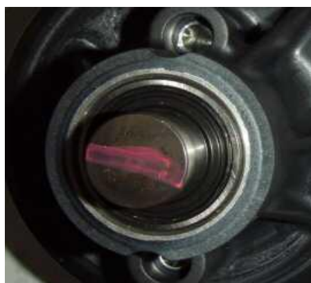
ゴム部品と射出した樹脂が隣接している
