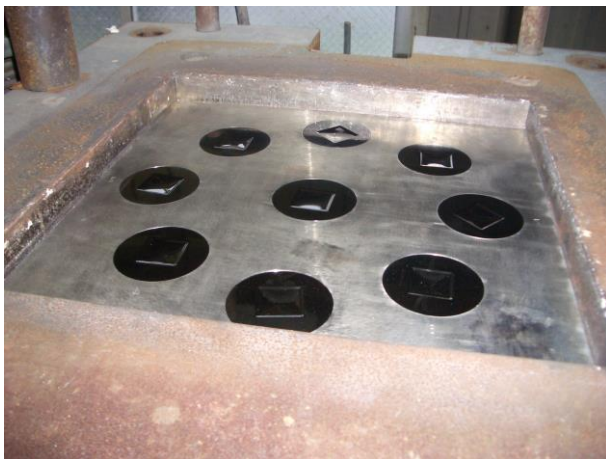
図34:良好に離型できた金型
