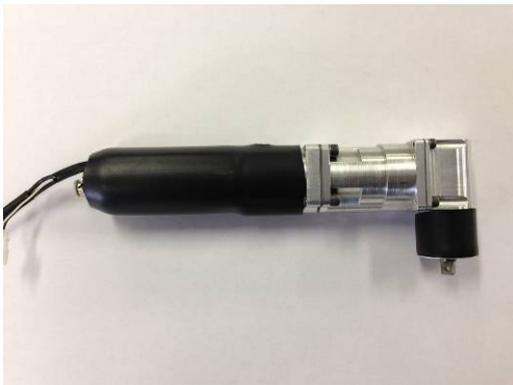
図 4 熱収縮チューブを巻きつけた試作機
