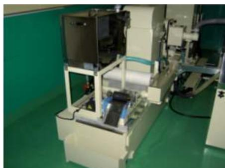
図7 CNC研削盤温度制御管理システム
