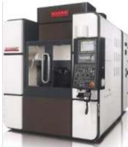
図8 多軸研削機
