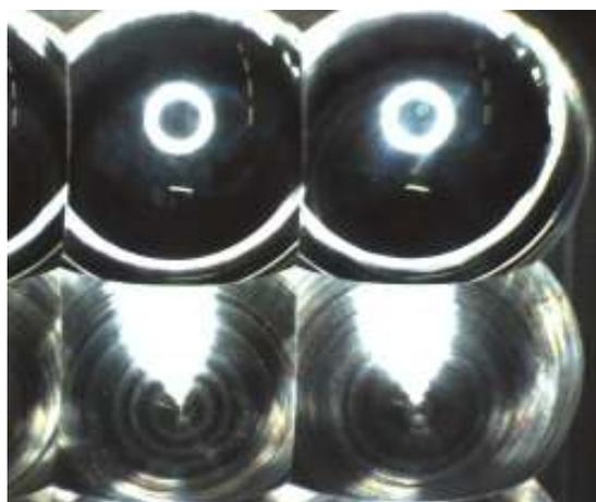
図53 ダミーレンズコアのミガキ後(上段)、ミガキ前写真(下段)
