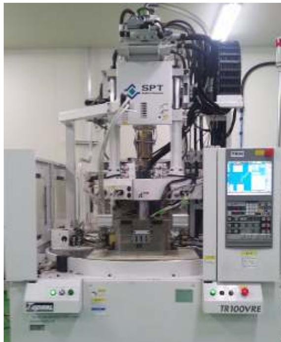
図5 超低粘度液状樹脂型成形機
