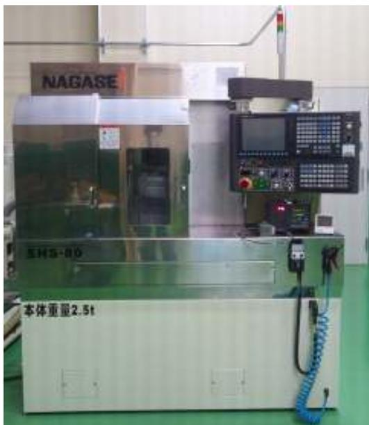
図6 精密CNC研削盤
