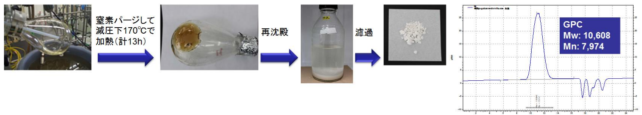
図 2-6-1 精製 D-乳酸モノマーの加熱重合による D-乳酸オリゴマー製造および分子量評価
