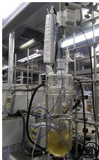
図 2-6-3 重合反応装置外観（2L）
