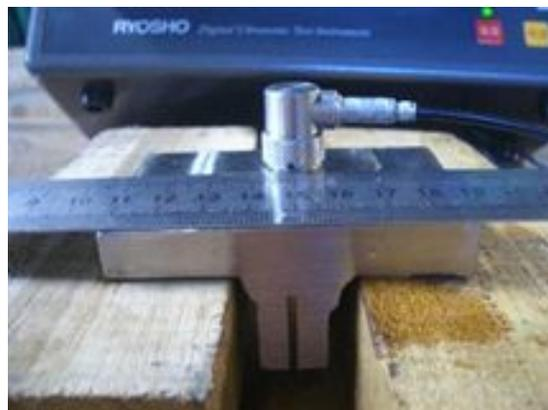
図 2.2.1.3 人工スリットに対する(相対的な)探触子の移動に伴う反射エコー高さの変化と試験状況の例
