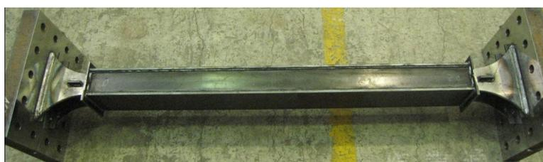
図2.3.1.2 Fe-Mn-Si系合金制震ダンパー試験体
