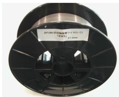
図 2.1.2.3 試作した同軸複合ワイヤ
