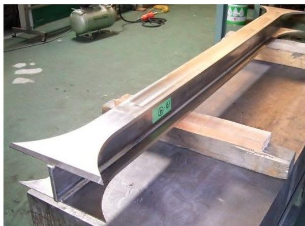
図 2.1.3.7 溶接を完了したH形鋼の全体外観
