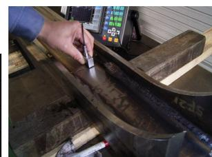
図 2.2.1.4 実機サイズ H 形鋼における突合せ溶接部の斜角探傷法の実施状況
