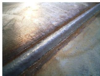
図 2.2.2.7 溶接ワイヤ矯正装置を使用して溶接施工した突合せ継手溶接の事例
