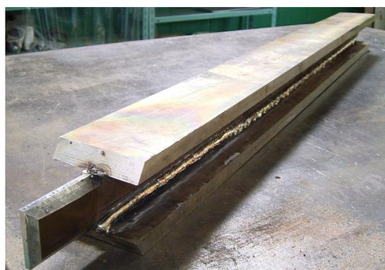
図 2.2.3 溶接システムで試作した H 型部材
