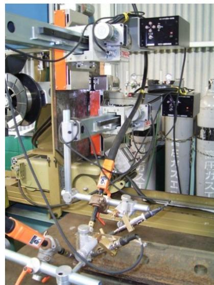
図 2.2.2.5 溶接放い装置を設置し、T 継手溶接施工状況
