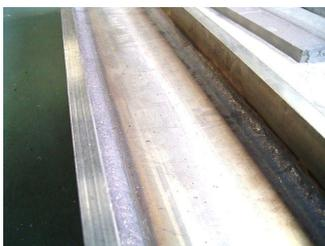
図 2.2.2.6 溶接ワイヤ矯正装置を使用して溶接施工した T 継手長手溶接の事例
