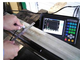
図 2.2.1.5 実機サイズ H 形鋼の T 継手溶接部にある不溶着部幅の測定状況
