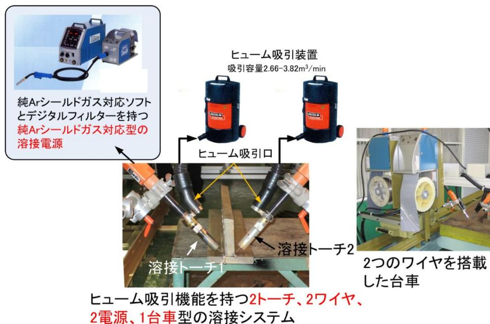
図 2.2.1 開発した Fe-Mn-Si 系合金用の溶接システム
