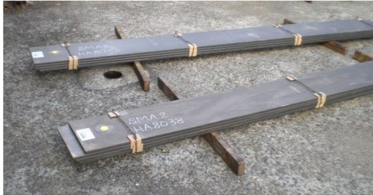
図 2.1.1.1 試作した実機制震ダンパー仕様幅の Fe-Mn-Si 系合金(低品位材)
