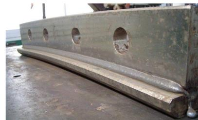
図 2.2.2.8 溶接放い装置を使用して施工した T 継手試験体
