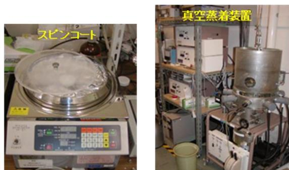
図3-1-2 有機半導体層・電極形成に用いた装置
