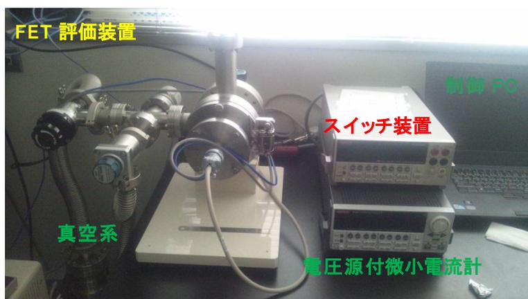
図 3-1-3 導入した F E T 評価装置写真
