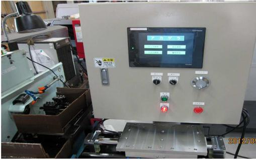
図 2-6-1 (コアレス装置制御盤)
