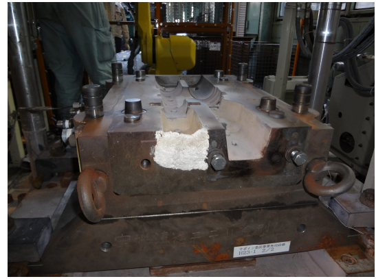
図1 モデル金型(A) (左) (200×300×肉厚 2mm), 傾斜鋳造機にセットした様子(右)
