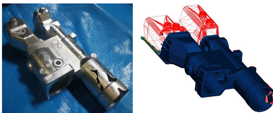
図 25 実鋳造品と解析結果の比較
