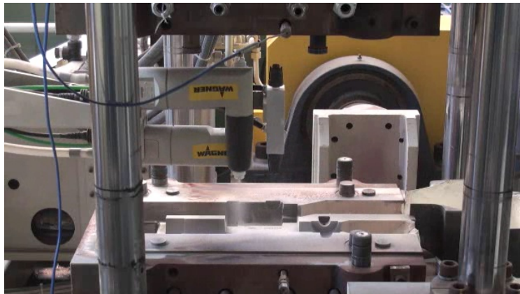
図2 ロボットアームに固定させたコロナチャージ方式の塗装ガンで金型に粉体離型剤を塗布する様子
