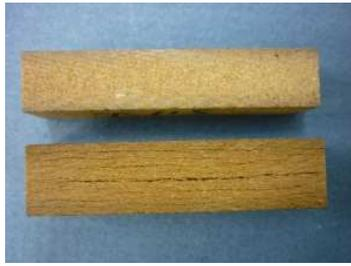
図 3-1-2 耐候操作による天然接着剤 MDF の割れの様子
