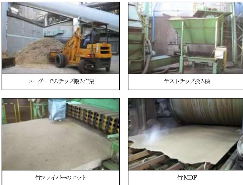
図2-1-1 竹MDFのライン試作時の様子
