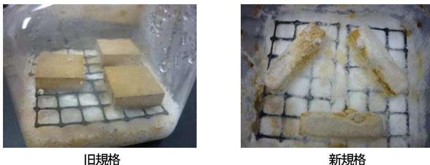
図3-1-1 耐朽性試験の様子
