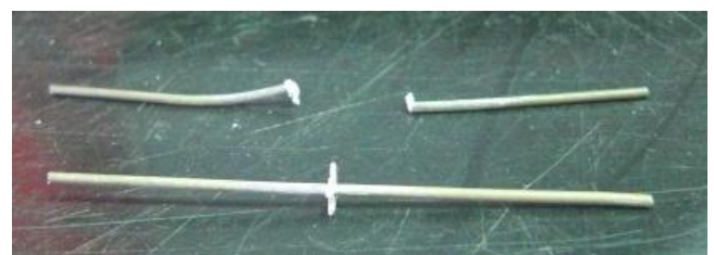
図 3-3-2 バット溶接したマグネシウム合金細線 上図：溶接不良品、 下図：溶接良品
