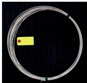
図 3-1-1 表面処理後の溶接ワイヤの外観
